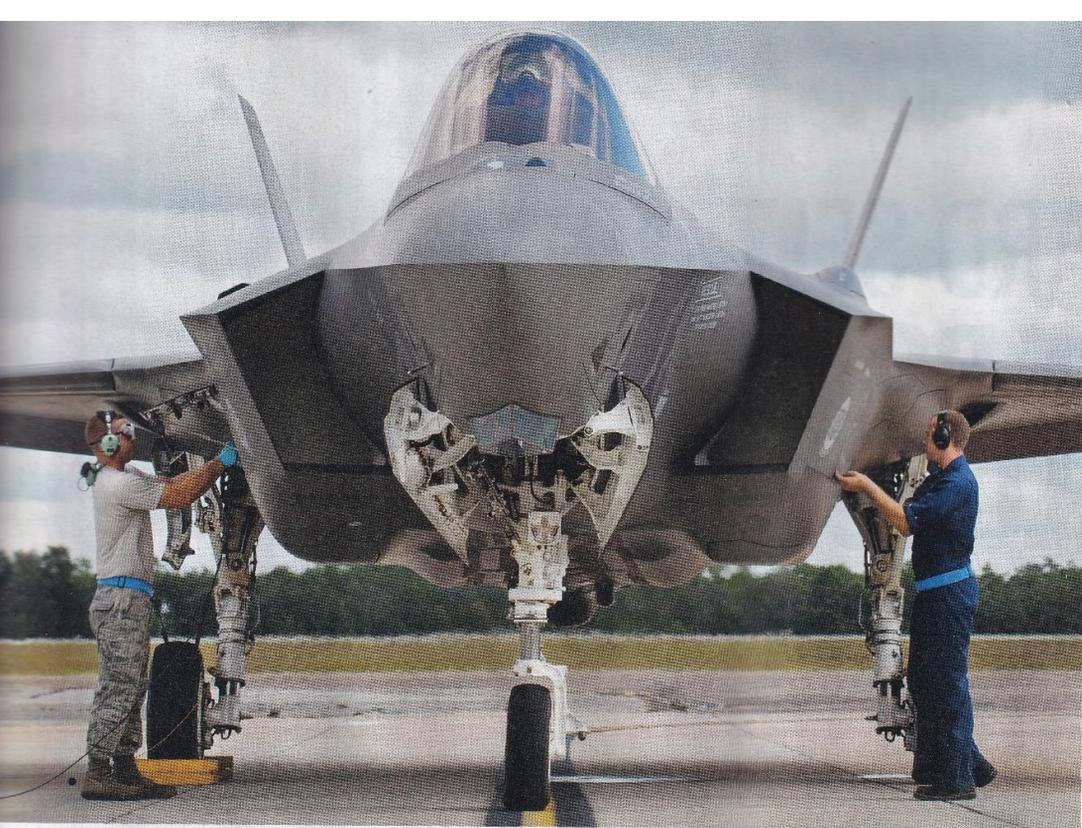
Les deux taches blanches et noires sur le nez de l'avion, juste sous la verrière, sont deux des six détecteurs infrarouges fournissant une vision à 360° autour de l'avion. Le cockpit est ultra-dépouillé grâce au grand écran tactile configurable par le pilote. Sous le nez du F-35, juste devant le train avant, une verrière en saphir protège l'EOTS, le système de ciblage électro-optique de poursuite infrarouge, qui affine l'analyse de l'environnement et la précision des frappes.
